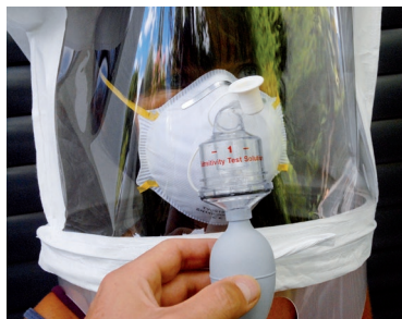
Prova di tenuta mediante speciale "FIT TEST" volto a verificare la corretta calzatura della maschera tramite test della soglia olfattiva.
