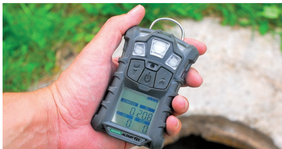
Misuratore di gas con 4 sensori (ossigeno, idrogeno solforato, monossido di carbonio e gas esplosivi). Prima di entrare in contenitori o pozzi chiusi o limitati, con una possibilità di inquinamento è sempre da eseguire una pianificazione di emergenza e una misurazione preliminare dell'atmosfera in essi contenuta. Gli operai devono essere istruiti e formati.
