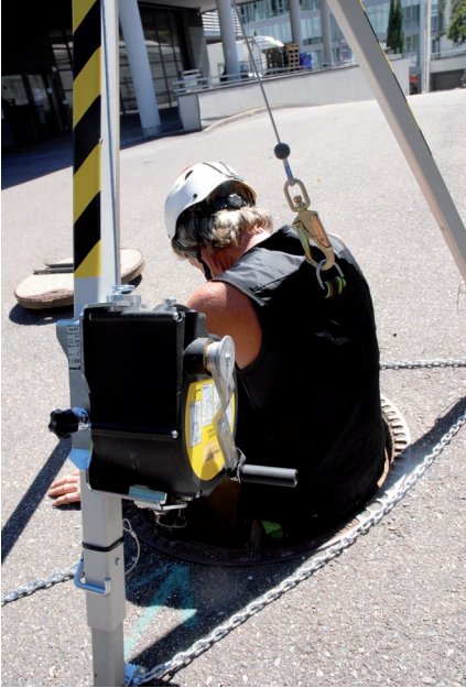
Treppiede e dispositivo anticaduta con funzione di recupero integrata (verricello) per la discesa in sicurezza all'interno di pozzi, serbatoi sotterranei e sili.
